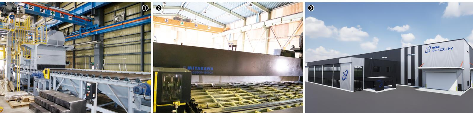
①「テスト工場」に新設したショットプラストマシン／②同じく「テスト工場」に導入したオートポラー (写真は「本社・木崎工場」第3工場の同機種) ／③2025年に開設する新工場の完成予定図 (CG)。群馬・埼玉の大小8拠点を集約する計画
