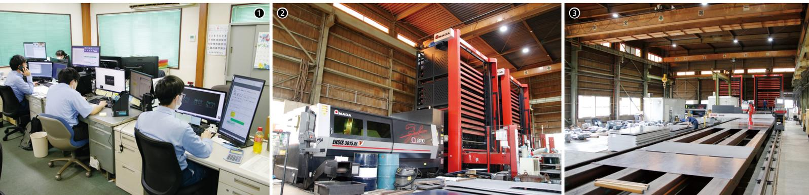
① 本社事務所のCAD/CAM工程。2022年にはミャンマーにCADセンターを設立した／②「萱野工場」で稼働するファイバーレーザーマシンENSIS-3015AJ (9kW) のパレットチェンジャー (15段×2列) 仕様／③「萱野工場」内部。手前に鋼板印字システム、奥にENSIS-3015AJ (9kW) が配置されている
