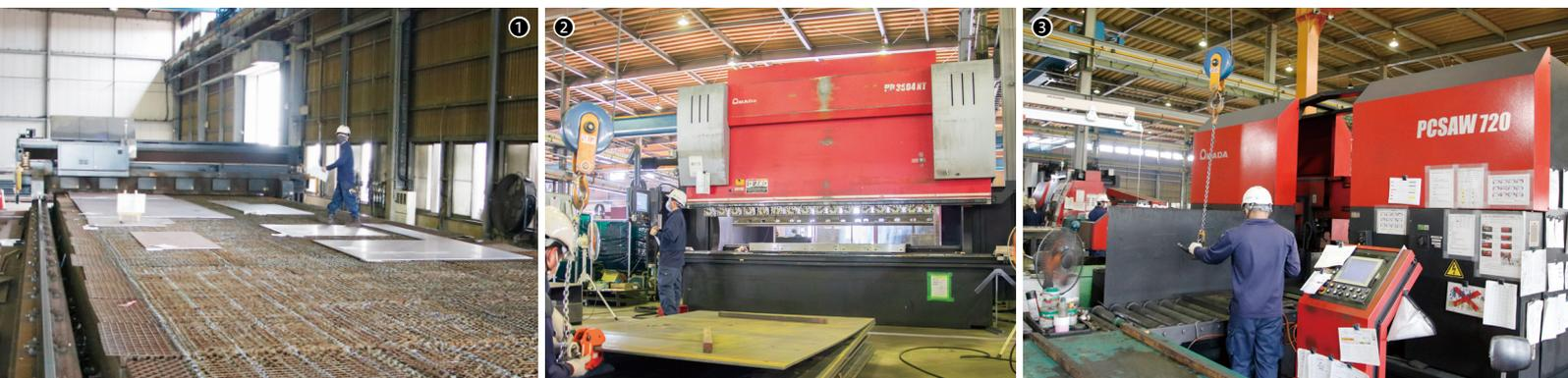
①「新田工場」で稼働する自走式ファイバーレーザ加工機（6kW）／②曲げ工程にはHD-3504NT（写真）とHD-1303LNTを設備している（新田工場）／③PCSAW-720（手前）など3台のバンドソーで鋼板・形鋼を切断する（新田工場）
